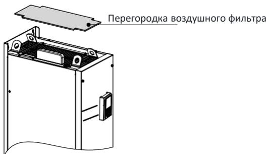
Рисунок 1-16 Снятие дефлектора воздушного фильтра
