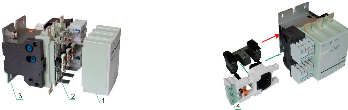
1: Дугогасительная система 2: Контактная система 3: Основание 4: Магнитная система
